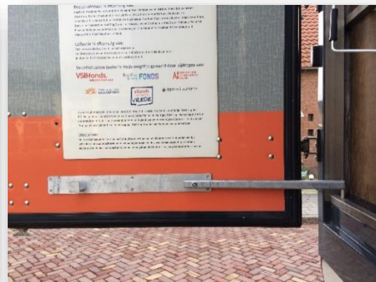
De deuren worden vergrendeld met de omslaande balken
